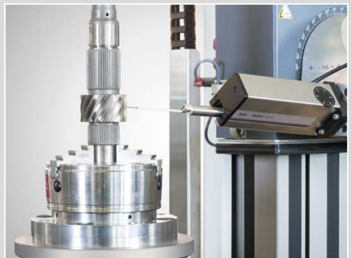
Flexible Rauheitsmessung an unterschied- lichsten Bauteilen (z. B. Getriebewellen)
