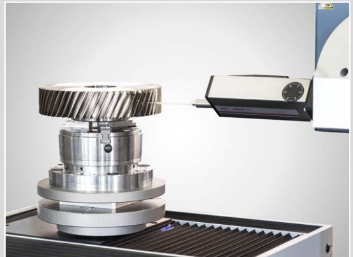
Rauheitsmessung auf schrägverzahnten Stirnrädern
