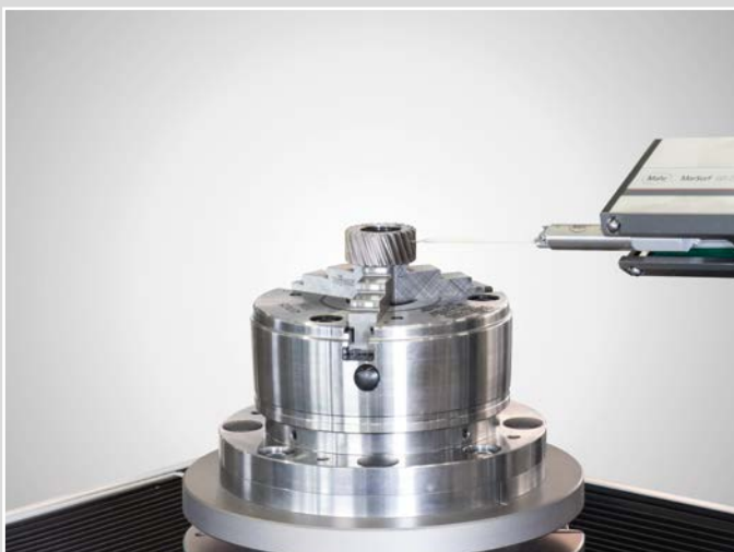
Messung in Bearbeitungsrichtung in kleinsten Zahnflanken (ab Modul > 1)
